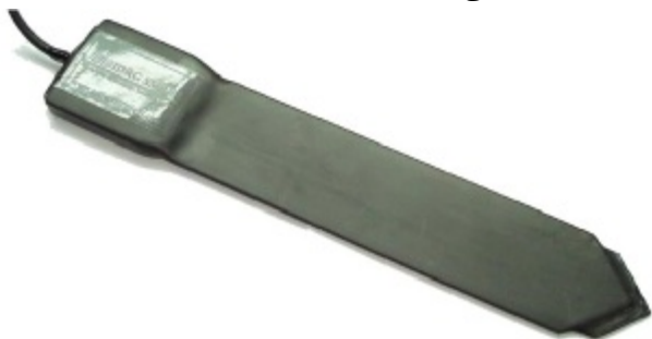
شکل 2- پروب رطوبت و دماسنج خاک
